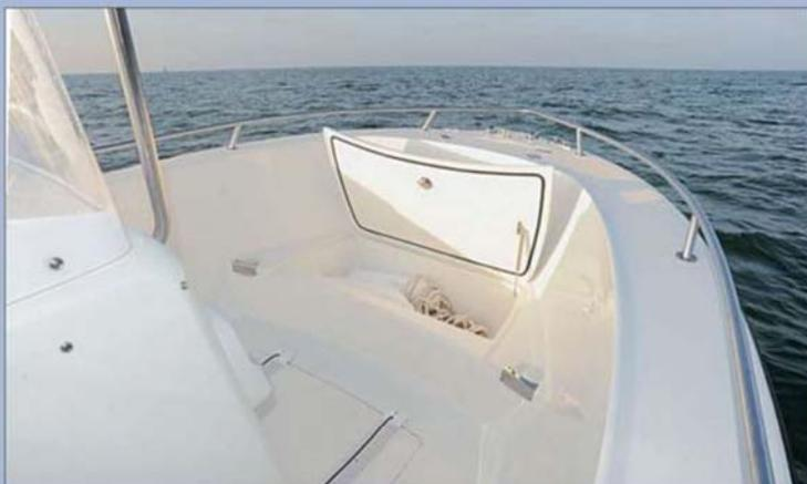
Sous la plateforme surélevée à l'avant du bateau, un grand coffre étanche fait office de bac à poissons. Un vérin pneumatique facilite le maintien du capot en position ouverte.
