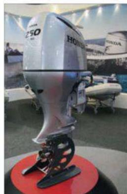
C'est le plus gros moteur quatre temps proposé par le constructeur nippon Honda. Le BF250 dispose d'un bloc de 3,6 litres de cylindrée avec un V6 à 60°. Comme les autres modèles, il bénéficie du système Blast permettant de profiter d'un couple important à bas régime et de la technologie VTEC d'ouverture variable des soupapes. Il est compatible avec les normes NMEA permettant une connexion avec l'instrumentation électronique du bord.
