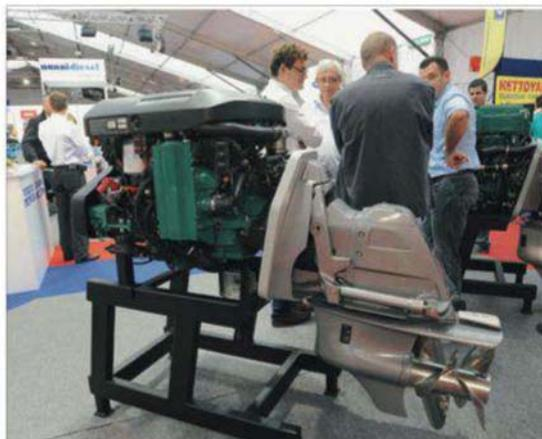
Le bloc D3 proposé par Volvo profite de nouveaux réglages de puissance, ce qui lui permet d'être proposé en 140, 170, 200 et 220 ch. Ce bloc de 2,4 litres de cylindrée avec 5 cylindres en ligne dispose de la technologie common rail et d'un turbo à géométrie variable pour plus de performances. Il peut être couplé à des hélices simples SX ou Duoprop en fonction du programme de navigation du bateau. Prix : 34877 € (D3-220 DPS).
