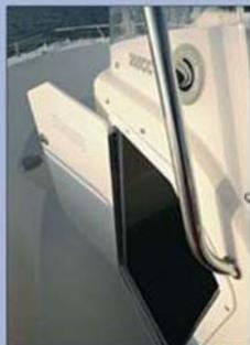
La baille montre des dimensions suffisantes pour recevoir un mouillage digne de ce nom, mais le davier ne fait pas partie de l'équipement. Une cabine est accessible dans la console centrale.
